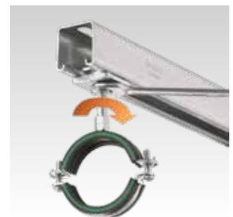
Gewindestift in den MPR-Schnellbefestiger eindrehen und mit Sechskantmutter kontorn. Anschließend Rohrschelle montieren.
