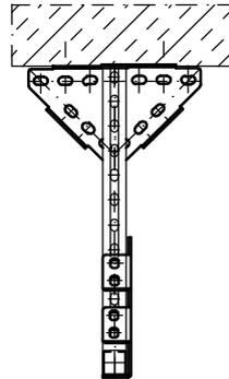
**En fixation transversale** pour renforcer la structure
