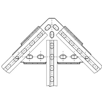
**En assemblage de rail**, l'ouverture du rail peut être positionnée selon le besoin
