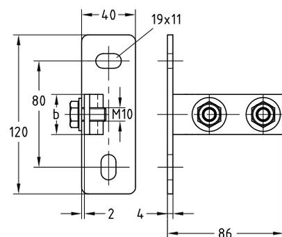
Té d'assemblage MPC, soudure longitudinale
