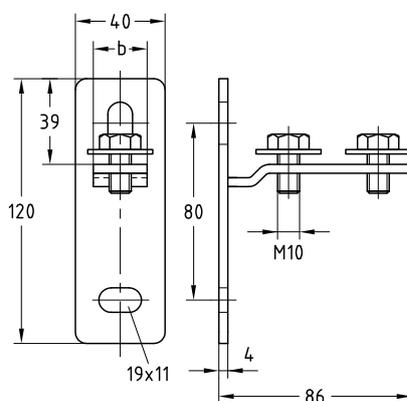
Té d'assemblage MPC, soudure transversale
