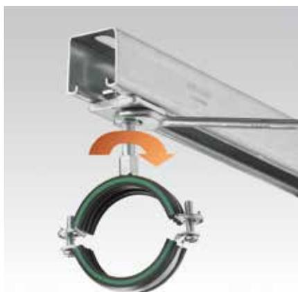
Visser la tige filetée dans la fixation rapide MPR bloquer celle-ci à l'aide d'un écrou hexagonal. Monter le collier.
