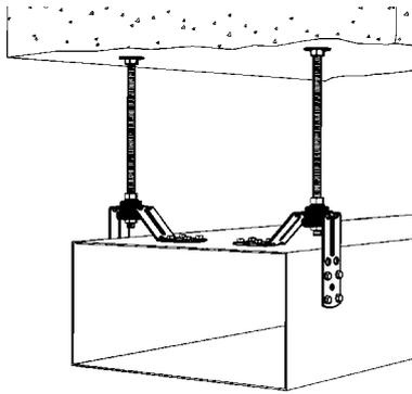
Fixation au plafond d'une gaine rectangulaire à l'aide de suspension insonorisée en V, tige filetée et cheville mécanique
