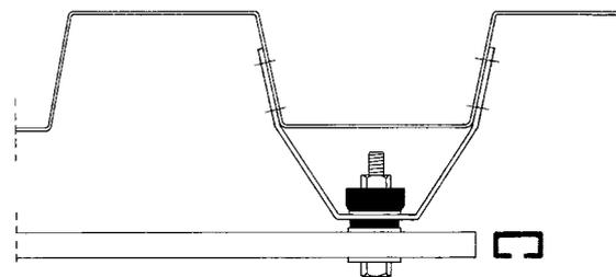
Fixation isophonique d'un rail d'installation sur un bac acier à l'aide d'une fixation insonorisée pour gaine
