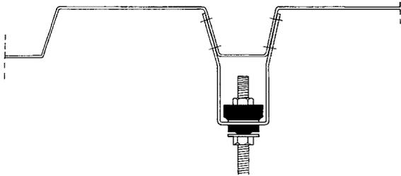
Fixation d'une suspension insonorisée en V, sur un bac acier
