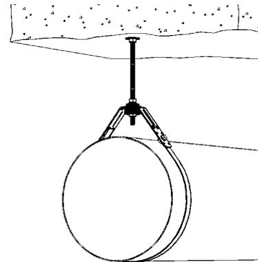
Montage au plafond d'une gaine circulaire à l'aide de suspension insonorisée en V, d'un feuillard ou d'une bande percée
